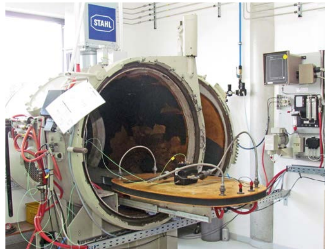
Geöffnete Splitterschutzkammer. Auf der herausgezogenen hellbraunen Platte liegt die schwarze Umhüllung mit dem Prüfobjekt im Innern. Über die dicken grauen Leitungen wird das Gas zugeführt.
