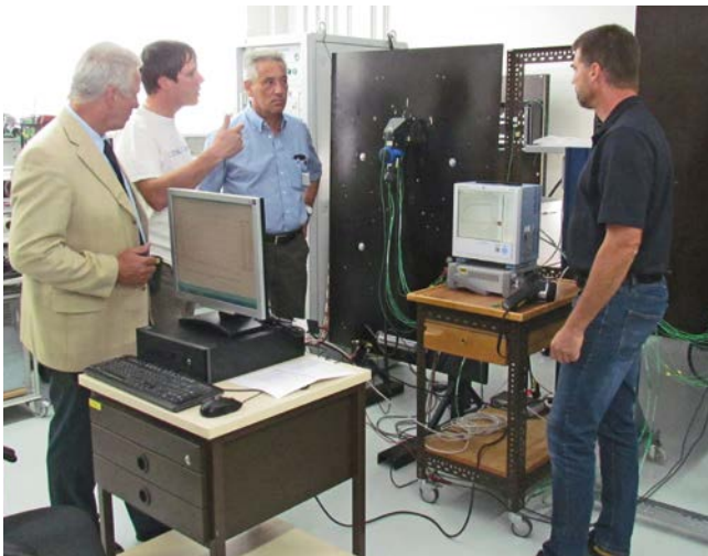
Messung der Oberflächentemperatur an einer Steckvorrichtung. Diese ist auf einer dunklen Wand befestigt und wird mit dem vorgegebenen Strom beaufschlagt. An mehreren Stellen sitzen Temperaturfühler, die mit dem Datenschreiber GP20 verbunden sind (grüne Kabel). Auf dem Bild sind (von links): Joachim Hausner (Yokogawa), Tobias Tiedt (R. STAHL), Johann Mathä (Yokogawa) und Bernd Küstner (R. STAHL) zu sehen.
