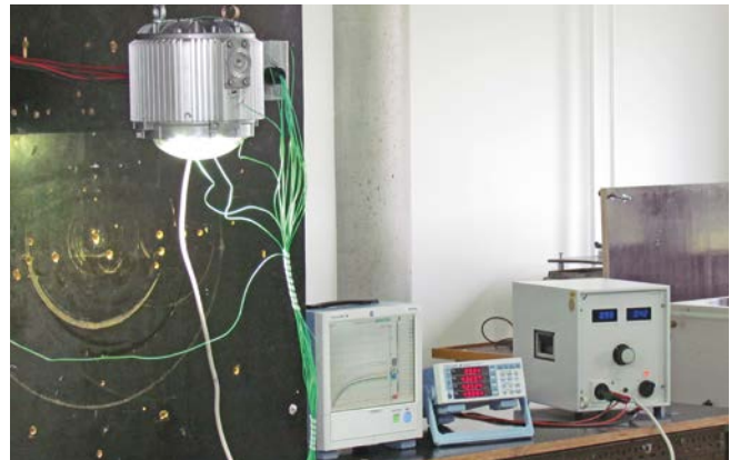
Testaufbau zur gleichzeitigen Messung von Leistungsaufnahme sowie Oberflächentemperaturen einer LED-Hängelampe.
