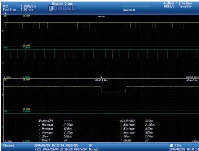
Kombinierte Darstellung der Trendanzeige und der schnellen Unterbrechungen inklusive statistischer Auswertung (beispielhafte Darstellung).
