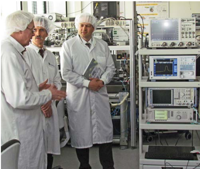
Dr. Klehr (links) erklärt Dietmar Gulich und Jörg Latzel (beide Yokogawa) den Messaufbau. Der OSA AQ6370D ist das zweite Gerät von oben.
