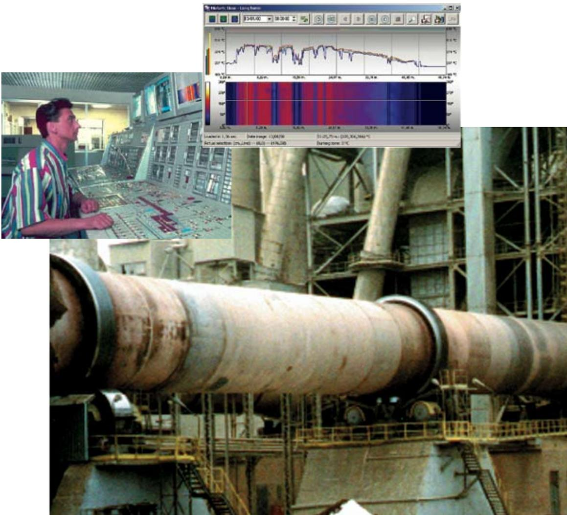
Das modulare System CS210 ermöglicht die Echtzeit-Überwachung der Oberflächentemperatur von Drehrohröfen
