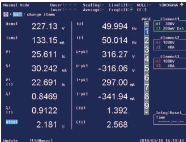
Simultane Messung von Leistung P1, Grundschwingungsleistung P1(1) und Spannungs-Klirrfaktor Uthd1
