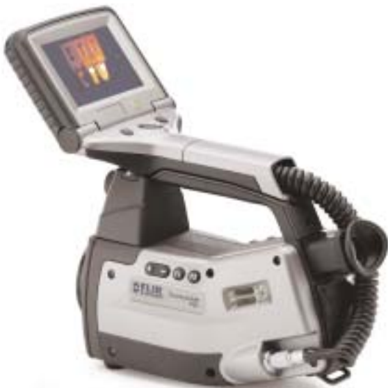
Thermografie-Kameras von FLIR: E2 im Taschenlampenformat (oben) und das High-End-Modell P60
