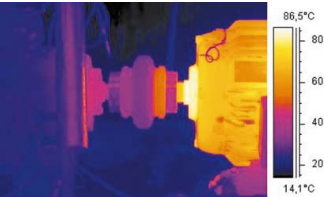
Kupplung und Elektromotor: die Wärme-Entwicklung an Verbindungsstellen kann Indizien für eine ungenaue Ausrichtung liefern
