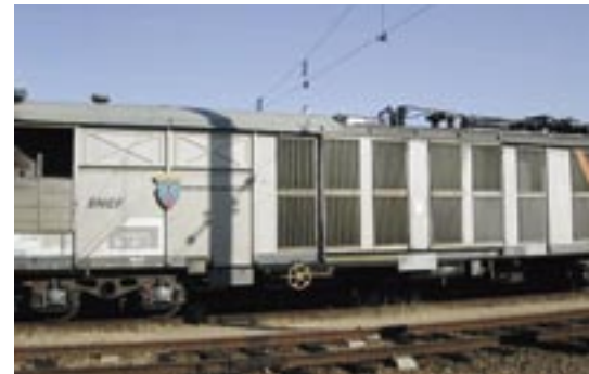
Der SNCF-Testwagen 'Vulcain', an dem zukünftig die Infrarotkamera zur Inspektion der Kettenfahrleitungen montiert sein wird.
