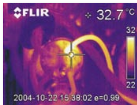
Verbindung in normalem und überhitztem Zustand
