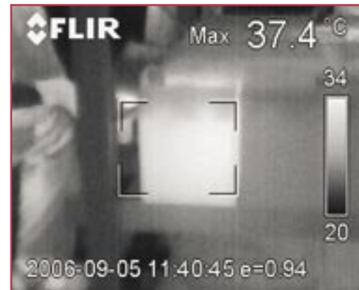
◆ USV-Batteriesatz: eine Batterie muss ausgetauscht werden
