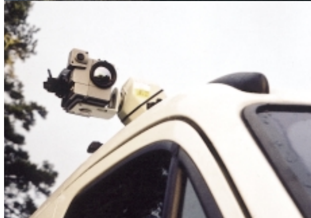
Arne Jensen AB hat eine Lösung konstruiert, bei der die Wärmebildkamera auf dem Dach eines Fahrzeugs montiert ist und über ein spezielles Bedienfeld im Innern des Fahrzeugs gesteuert wird.
