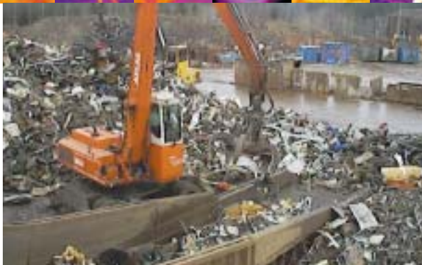
Beladen des Förderbandes mit Schrott
