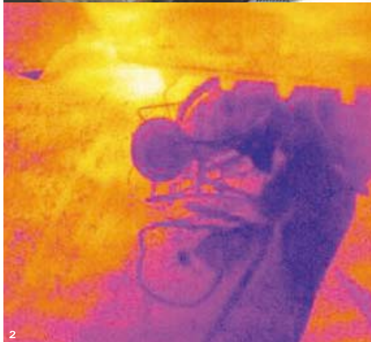
1. Kontrollraum mit IR-Bildschirm unten links im Bild 2. Fahrrad auf dem Förderband erkennbar, trotz Wasserdampf im Sichtfeld der IR-Kamera
