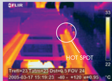
Das Wärmebild: Reibung am Rand des Förderbands zwischen Metall und Kunststoff führt zur Erwärmung des Testkoffers / Transportcontainers.
