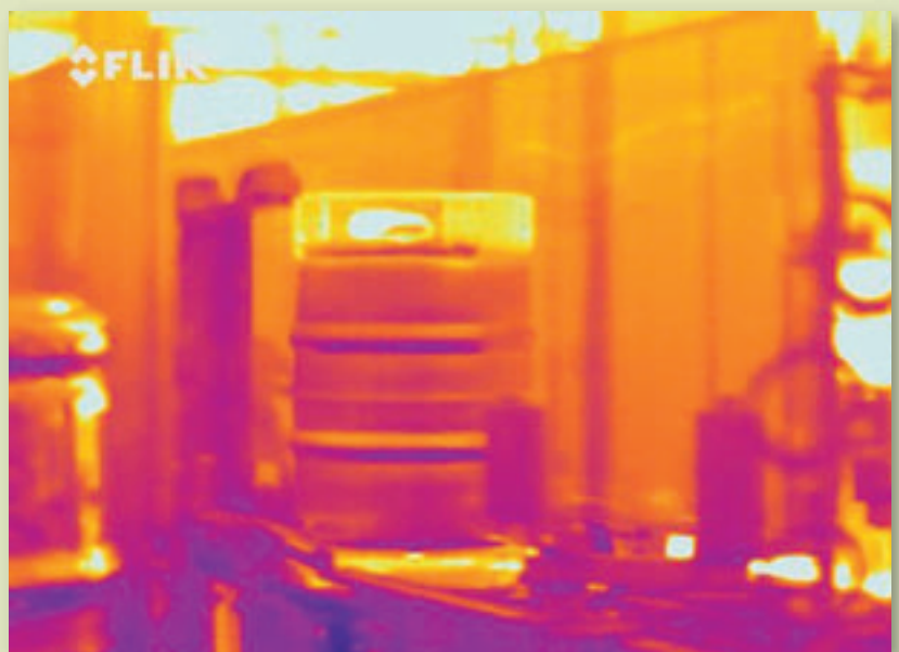
Wärmebild eines gefüllten Bierfasses.
