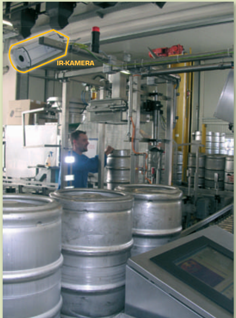
Volle Bierfässer werden von der Wärmekamera (ganz oben links im Bild) kontrolliert. Rechts unten auf dem Bild erkennt man den Touchscreen-Monitor des Bedieners.
